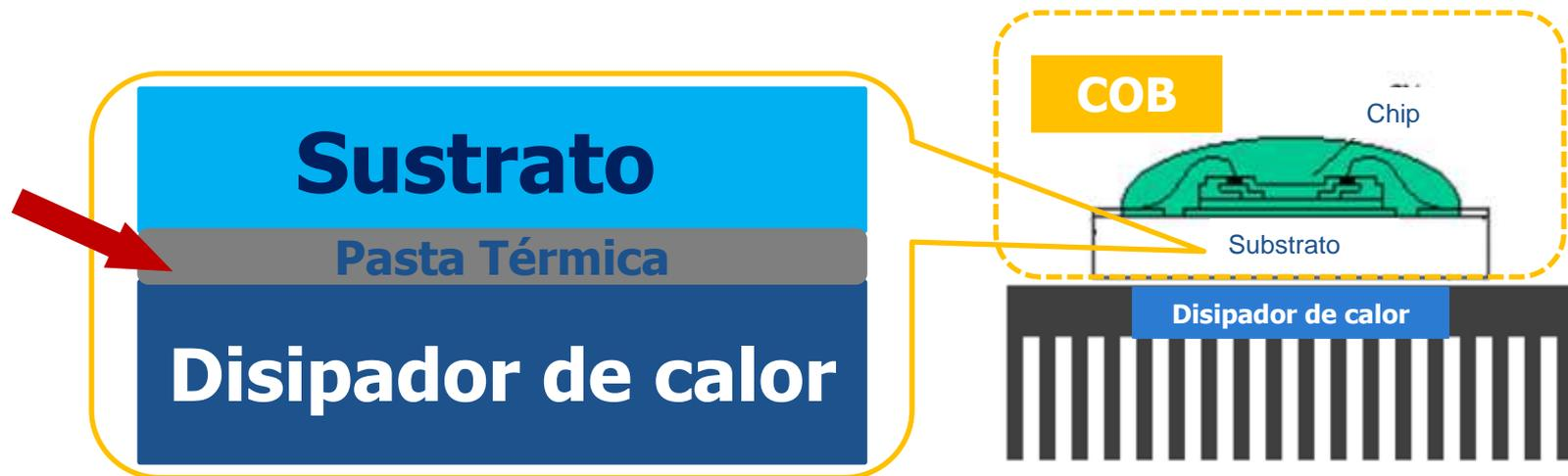
**La brecha entre el sustrato y el disipador de calor queda 100% sellada.**
